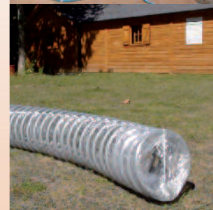
1/ Capteurs horizontaux en place. ©BRGM. 2/ Nouveaux échangeurs dits "compacts". ©BRGM.
